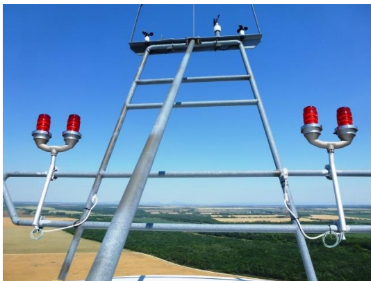
Abb. 8 - Sicherheitseinrichtungen auf dem Dach der Gondel mit zwei Windmessern und einer Windfahne
