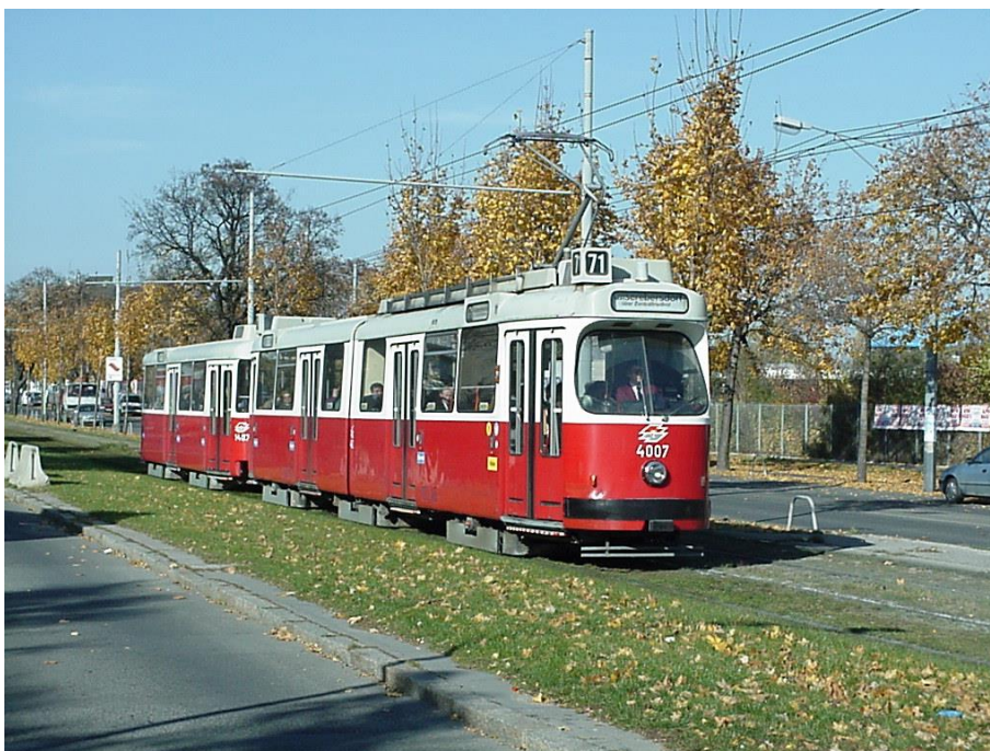
Foto 1: Straßenbahntriebwagen vom Typ E2 samt Beiwagen vom Typ c5 (Quelle: Wiener Linien, Zustand vor der Nachrüstung mit einem Außenspiegel).
