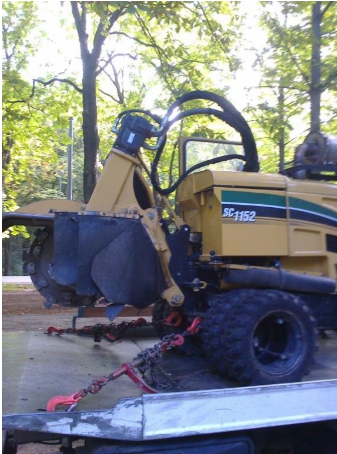
Abbildung 2: Auf einen Lastkraftwagen aufgeladene Wurzelstockfräse
