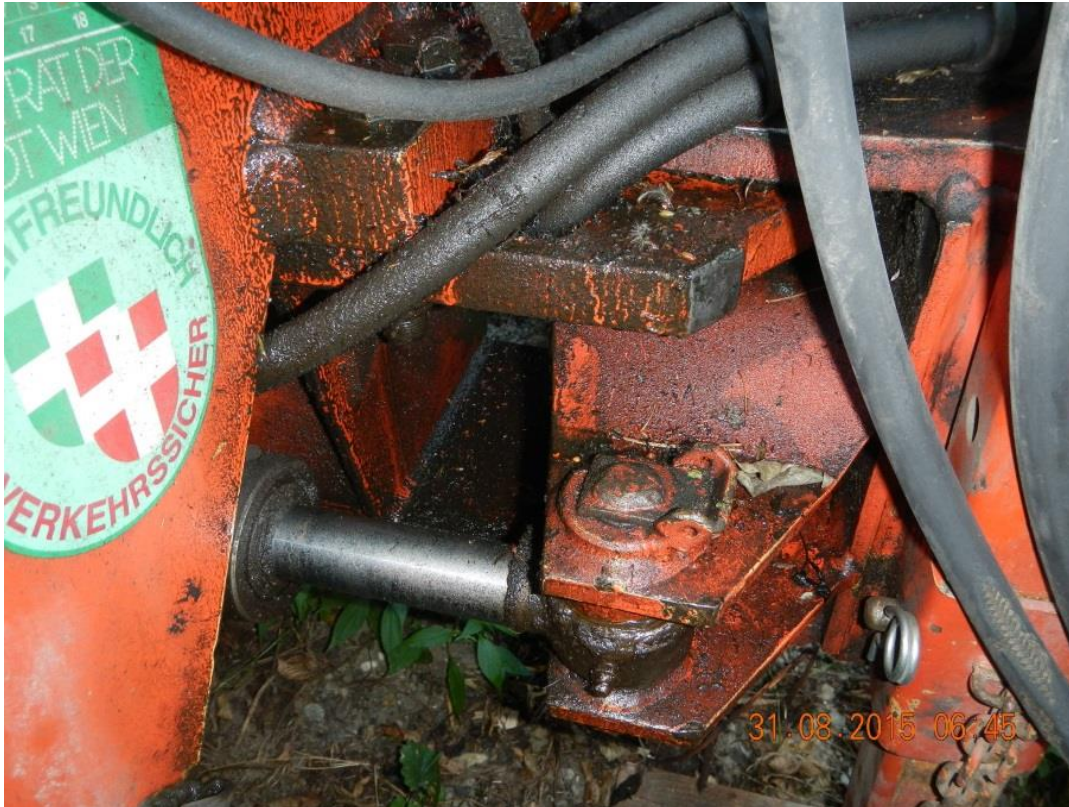
Abbildung 2: Anhänger mit Kippfunktion und Ladekran, Ölleckagen an der Hydraulik
